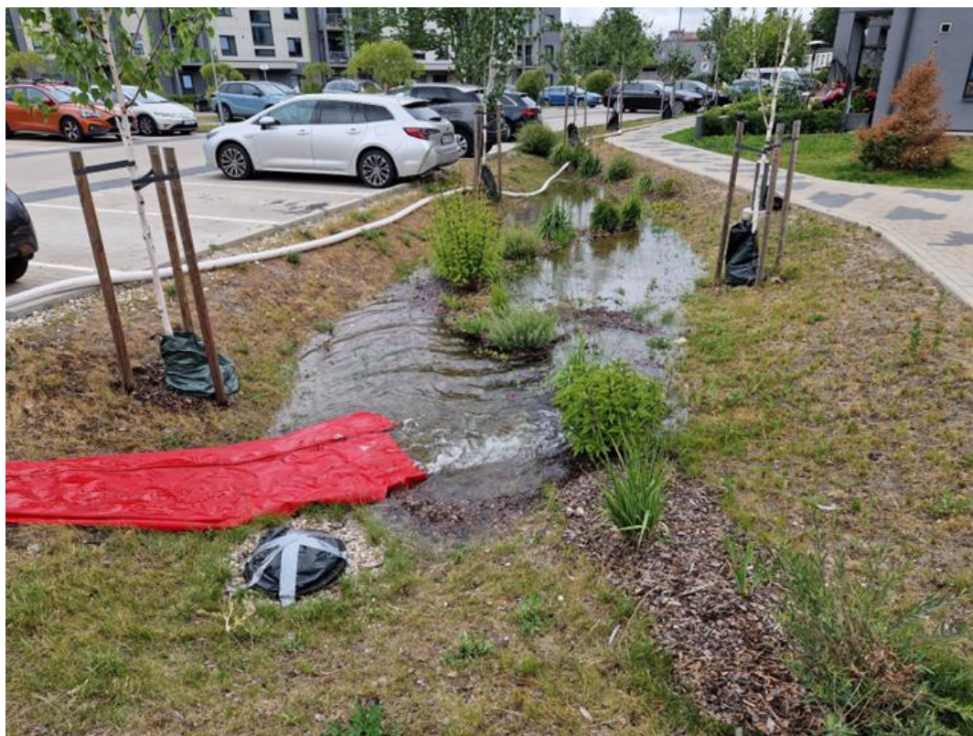
18. attēls. Infiltrācijas tests 2.ievalkā Turaidas ielā 4
