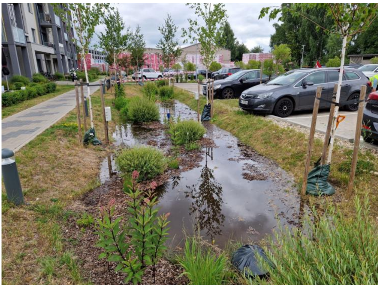
14. attēls. Infiltrācijas tests 1.ievalkā Turaidas ielā 4
